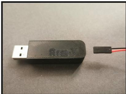
Подключите Desire V3 SVD к аккумулятору. Важно: не размещайте устройство на металлических предметах, не допускайте попадания металлических предметов между платами и избегайте контакта клемм мотора Desire V3 SVD с элементами платы.
