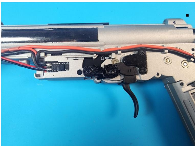
Для СВУ: На Desire V3 SVD установлен датчик переключения режимов огня. Чтобы он корректно работал на СВУ, необходимо доработать толкатель, который ранее поднимал отсекальщик одиночного огня, или заменить его, распечатав новый по 3D-модели, доступной по ссылке.
